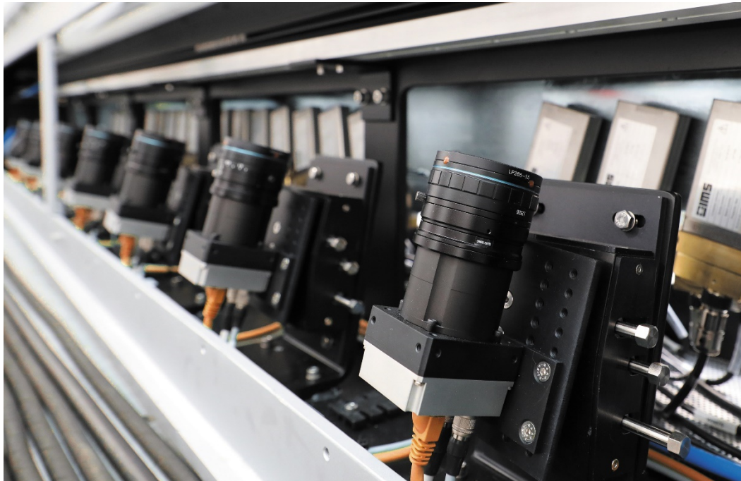
Abbildung 2 (Quelle IMS Messsysteme GmbH): 100% Online-Inspektion mit Hochleistungs-LEDs und schnellen Zeilenkameras
