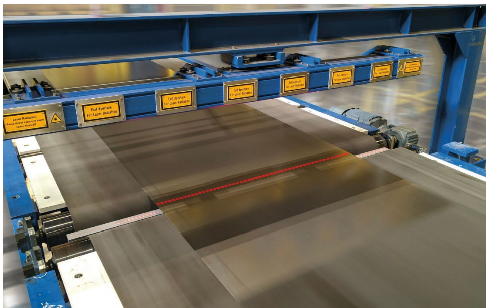
Abbildung 1: In Clustern gebündelte, intelligente Kameras garantieren selbst auf hochglänzenden Materialien höchste Messgenauigkeiten bei der Planheits- / Ebenheitsmessung
