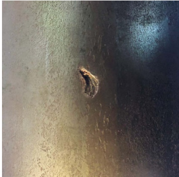
Bild 2: Foto sichtbarer Fehler „Eindruck“ auf der Rohroberfläche (Quelle: voestalpine Tubulars)
