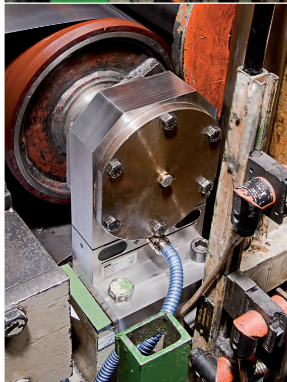
von oben nach unten: vorher: Rolle ohne Kraftaufnehmer nachher: Rolle mit Kraftaufnehmer
