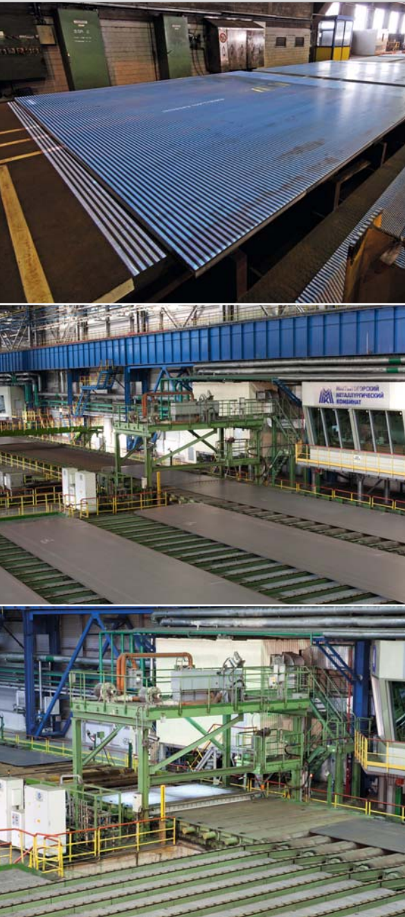
von oben nach unten: Streifenprojektion auf einem Messtisch Ebenheits- und Außenkonturmessung im Auslauf des Kühlbettes
